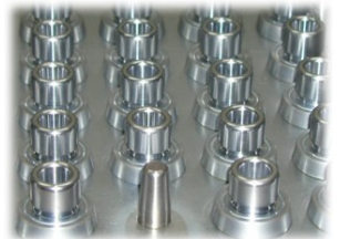
Кассетированная пресс-форма для производства защитного чехла рабочего тормозного цилиндра автомобиля ВАЗ.
